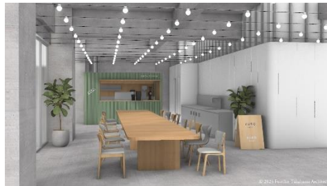
仮囲いのパネルやガルバリウム鋼板の波板など外部で使用する素材を象徴的に使用
